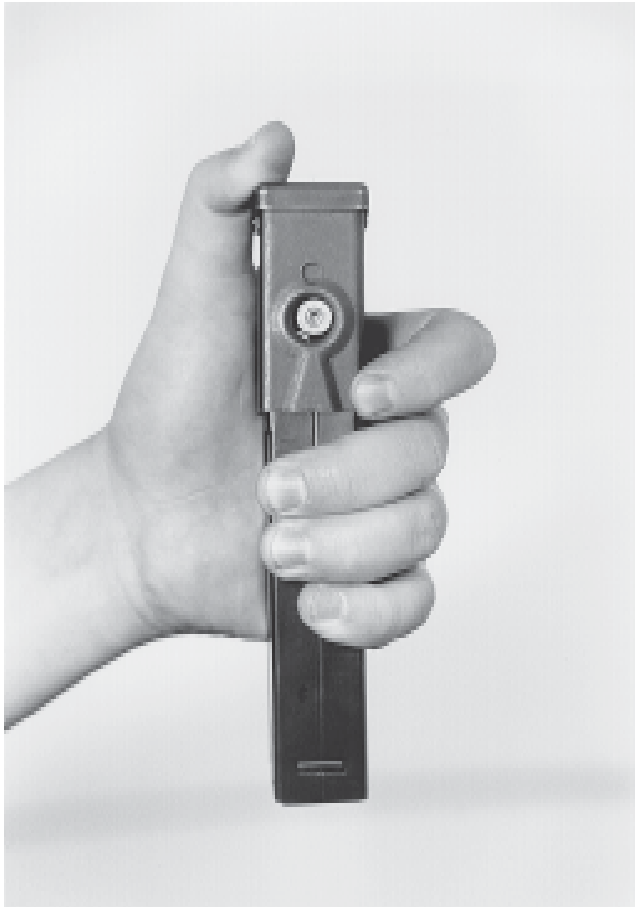
Aufmunitionierhilfe nach unten drücken
