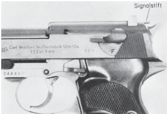
Pistole P1 fertiggeladen, entspannt, entsichert
