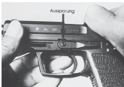
Lage Aussparung/Verschlussfanghebel Verschlussfanghebelachse Zerlegen der Pistole
