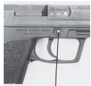
Lage Aussparung/Verschlussfanghebel Verschlussfanghebelachse Zerlegen der Pistole
