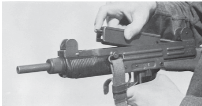
Verschluss mit Schließvorrichtung herausheben
