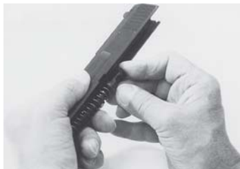
Pufferstange (vollständig) herausnehmen
