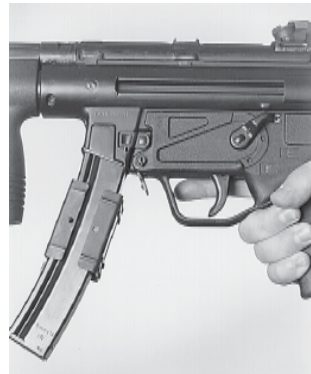
Magazin mit Magazinklammer in Magazinschacht eingeführt
