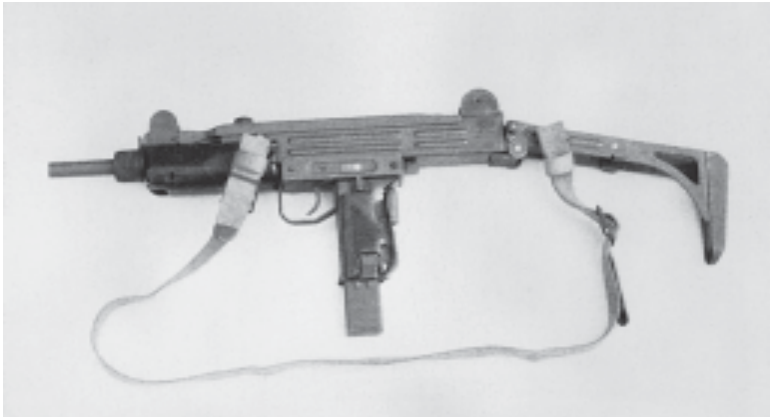
Maschinenpistole MP2A1 mit klappbarer Schulterstütze (aufgeklappte Schulterstütze)
