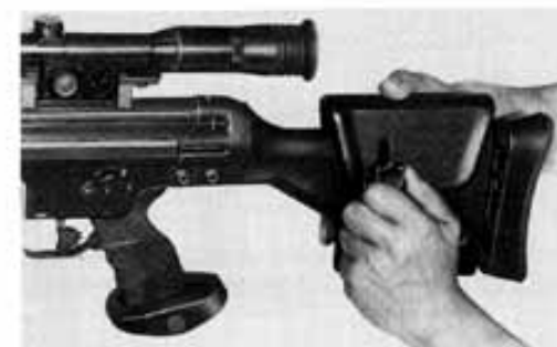
Bild 14: Höhenverstellung der Schulterstütze
