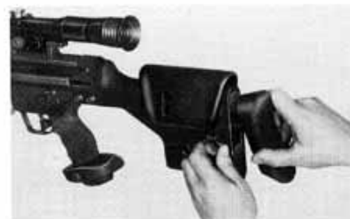
Bild 13: Längenverstellung der Schulterstütze
