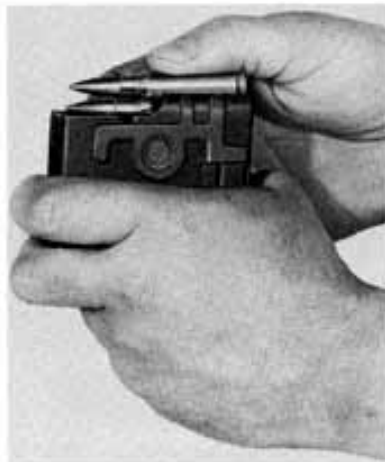
Bild 17: Füllen des Magazines
