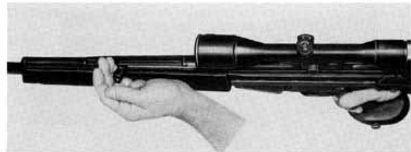
Bild 19: Zurückziehen des Ladehebels
