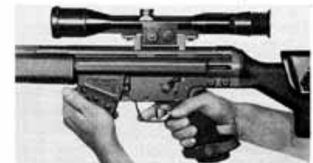
Bild 26: Einführen des Magazines
